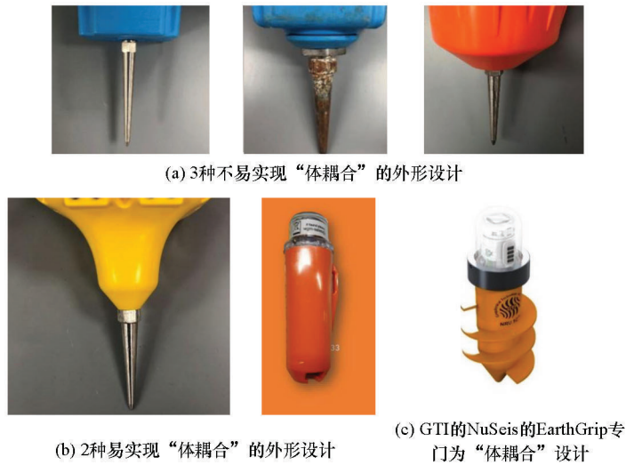
图 4 几种节点的耦合部分设计
