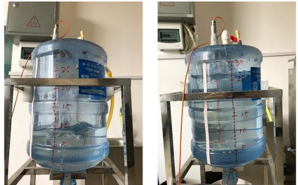
图 3 两种不同水位高度气泡溃散形成的水柱
