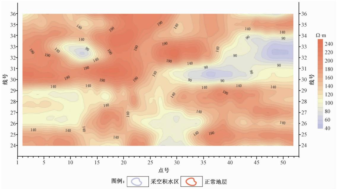
图 5 顺层视电阻率切片趋势分析成果图
