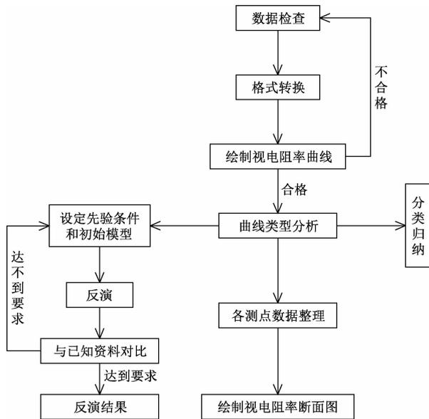
图 4 瞬变电磁法资料处理与解释流程图
