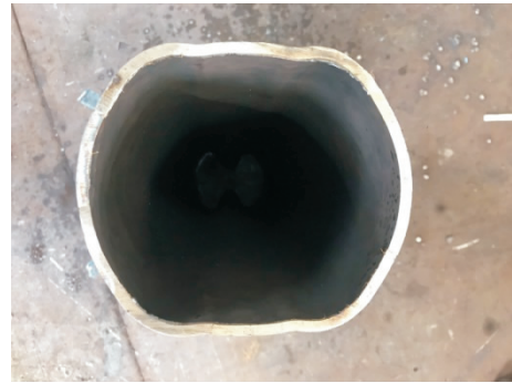
注: TG03 波纹管最大膨胀压力为 12.5 MPa, 膨胀后截面尺寸 D_1=119\text{ mm} , D_2=137.8\text{ mm} , D=137\text{ mm}
