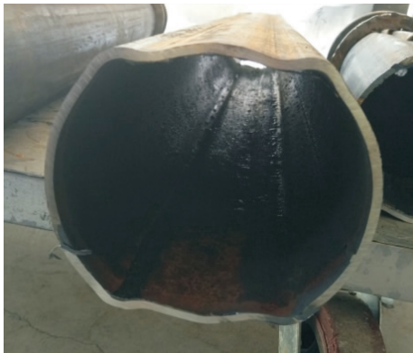
注: TG02 波纹管最大膨胀压力为 13.6 MPa, 膨胀后截面尺寸 D_1=117.8\text{ mm} , D_2=137.6\text{ mm} , D=131.6\text{ mm}
