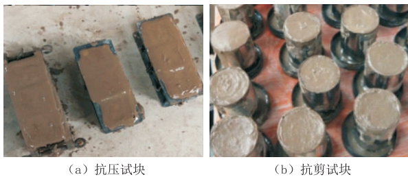
图 1 制备好的水泥土试样
