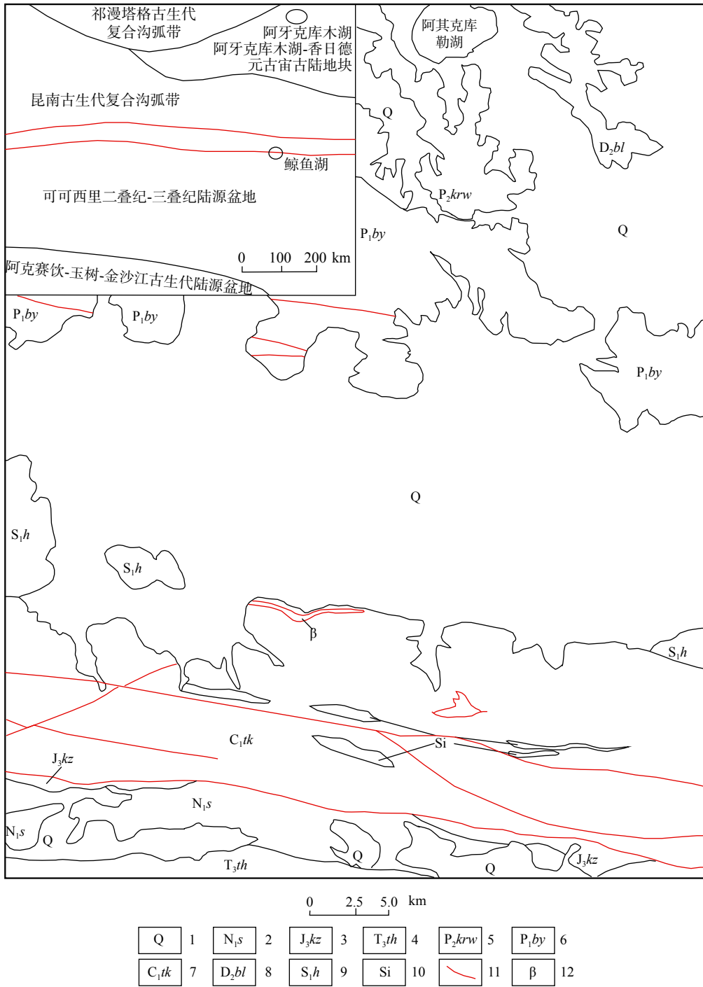
1.第四系；2.喷呐湖组；3.库孜贡苏组；4.桃湖组；5.喀尔瓦组；6.碧云山组；7.托库孜达坂组；8.布拉克巴什组；9.哈拉巴依沟组；10.硅质岩；11.断层；12.玄武岩
