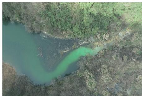
图 9 小米溪沟河水汇入主河道后的白色胶状物照片
