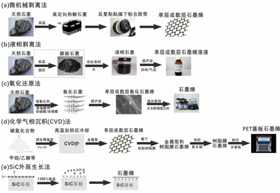
图 2 石墨烯制备工艺图 Fig. 2 Manufacturing process chart of graphite
