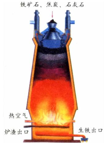
图 5 炼铁高炉及炉内化学变化过程示意图
