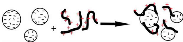
图 3 “静电贴片”形成过程示意图
