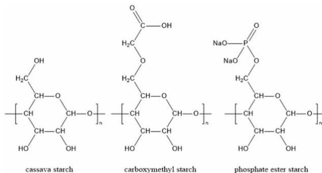
图2 木薯淀粉、羧甲基淀粉和磷酸酯淀粉的化学结构式
