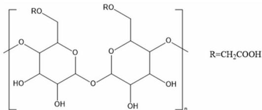
图3 羧甲基纤维素的化学结构式
