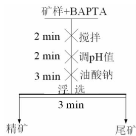
图 3 浮选试验流程 Fig. 3 Flotation process test
