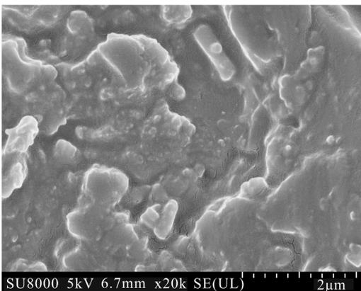
图4 柯尔碱膨润土原土及其热产物的扫描电镜照片
