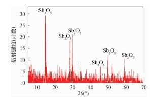
图 1 溶样后析出沉淀的 X 射线衍射图谱
