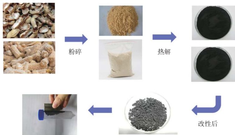
图1 生物炭-壳聚糖磁性复合材料合成示意图
