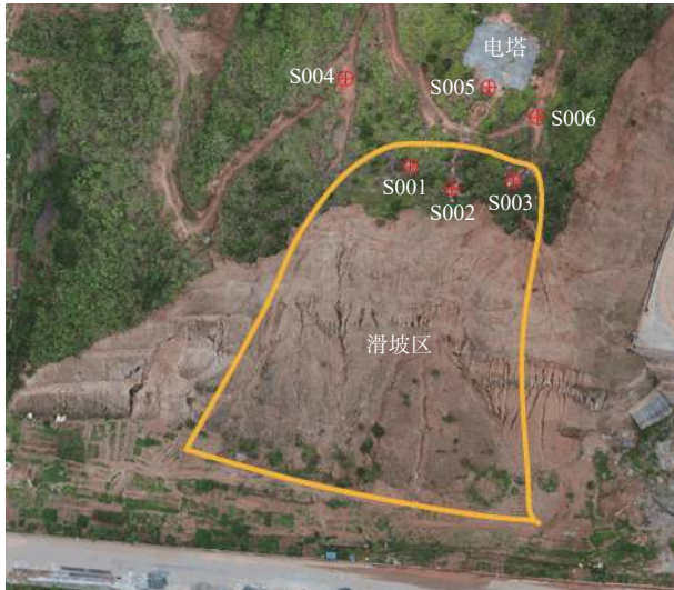
图3 边坡范围及监测设备布置情况
