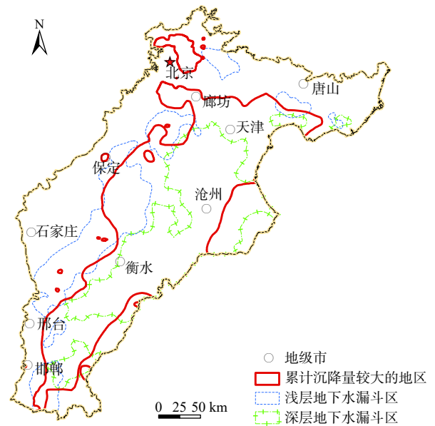
图1 京津冀平原主要浅层和深层地下水漏斗以及累计沉降量较大地区(大于50 cm)分布图
