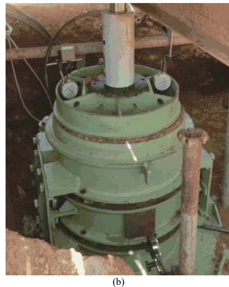
图 6 双剪面自反力大型原位直剪仪正视图 (a) 及实体仪器 (b)
