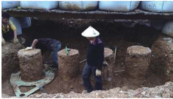
图 9 自反力双剪面大型剪切仪应用现场试样修整图
