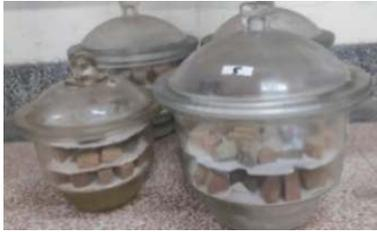
图 2 蒸汽平衡法的密闭容器
