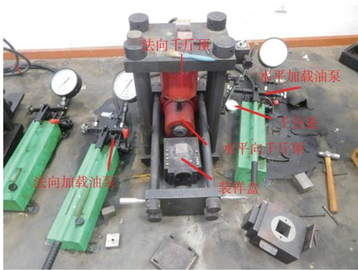
图 4 YDS-2 型便携式岩土力学性质多功能测试仪
