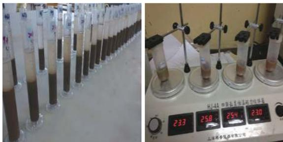
图 3 自由膨胀率实验 (左) 及阳离子交换量实验图 (右)
