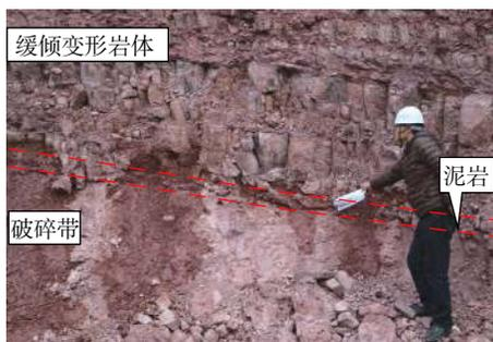
图 3 滑坡前缘下部的破碎带
