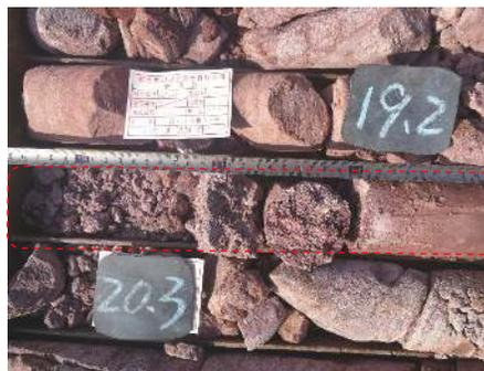
图 7 钻孔 ZK01 揭露中部底滑面特征
