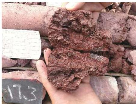
图 6 钻孔 ZK03 揭露后缘底滑面特征
