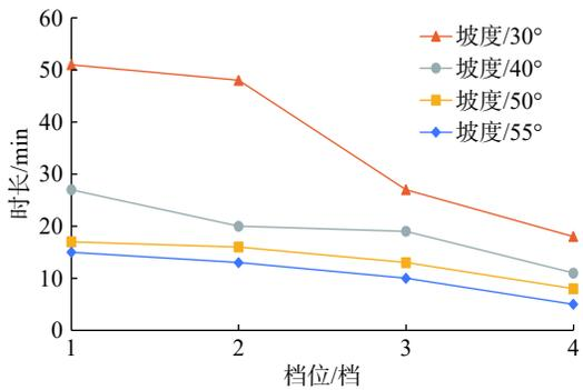
图 6 四种不同坡度条件下降雨强度与斜坡变形破坏所需的降雨时长关系曲线
