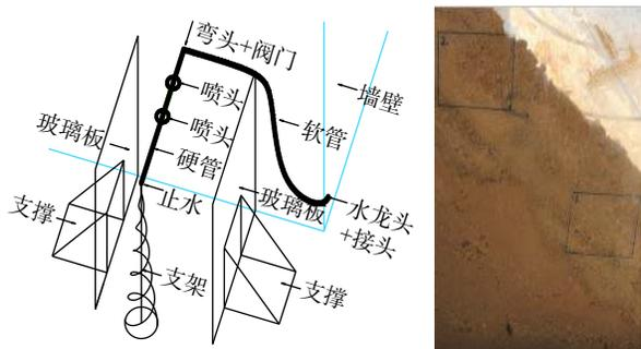
图 1 模拟降雨装置布置方案示意图及坡体侧面上、中、下定点观测框
