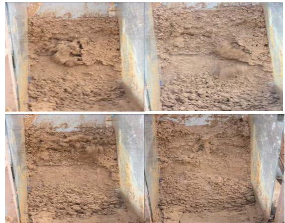
图 4 斜坡块体滑塌破坏后的形态
