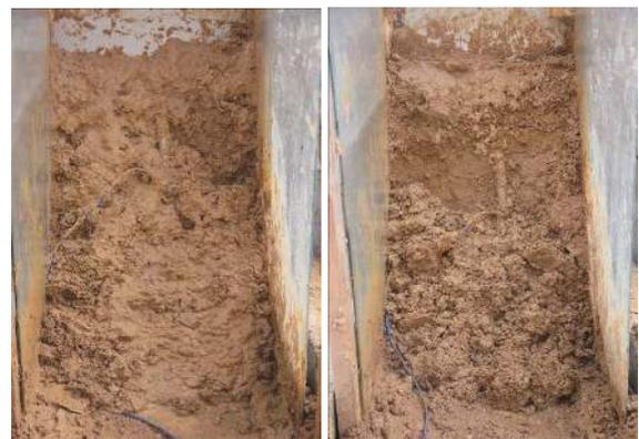
图 5 斜坡深层整体滑塌失稳破坏形态
