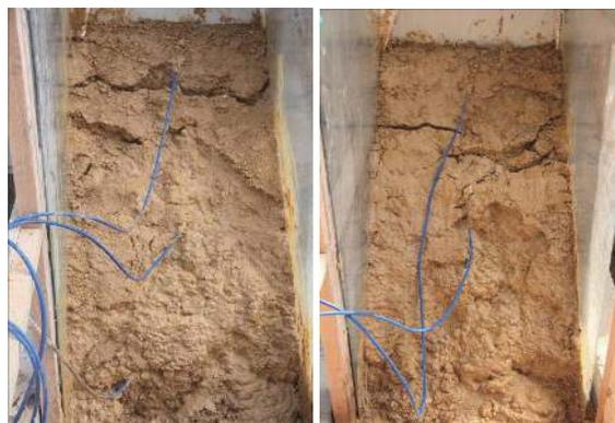
图 2 坡体浅层出现破坏裂纹及形态
