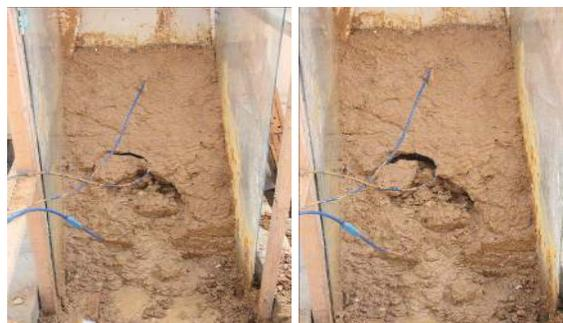
图 3 斜坡浅层局部块体滑塌形态
