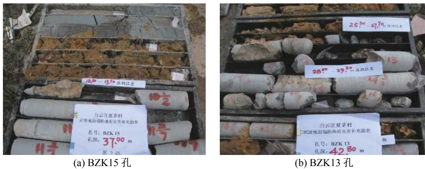
图 2 BZK15 孔岩面溶沟形态和 BZK13 孔岩面溶沟形态
