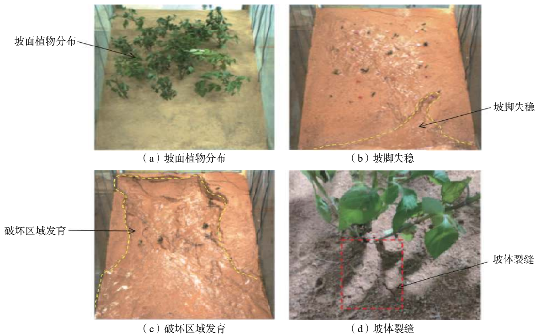
图 9 台风暴雨作用下的滑坡演化过程
