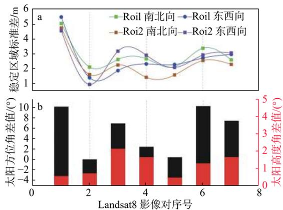
图 9 太阳高度角差值和太阳方位角差值与稳定区域标准差的关系
