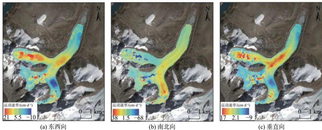
图 10 联合解算的冰川表面运动速率分布
