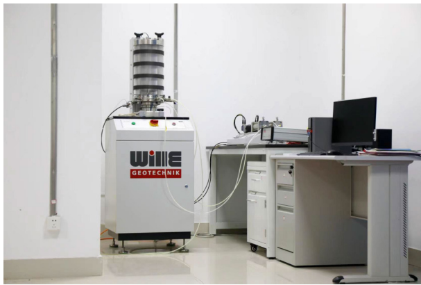
图2 伺服电机控制动三轴试验系统
