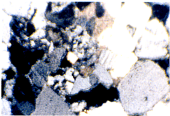
图 3 粘土矿物呈隙晶带状。碳酸盐矿物零星散布于岩石中。粘土矿物和碳酸盐岩矿物胶结碎屑。颗粒支撑,孔隙式胶结
