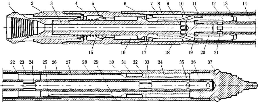
图1 CJ-130型双向气动潜孔锤的结构和工作原理示意图
