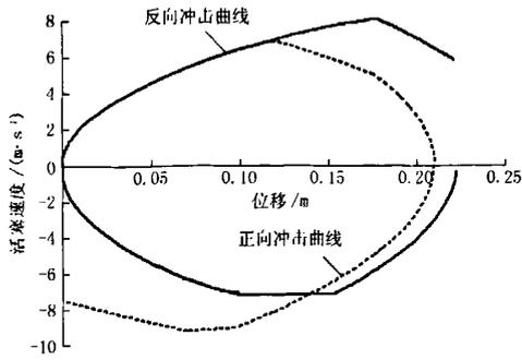
图3 活塞速度与位移关系曲线
