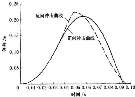
图4 活塞位移与时间关系曲线
