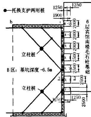
图3 桩撑结构和托换支护桩平面布置图
