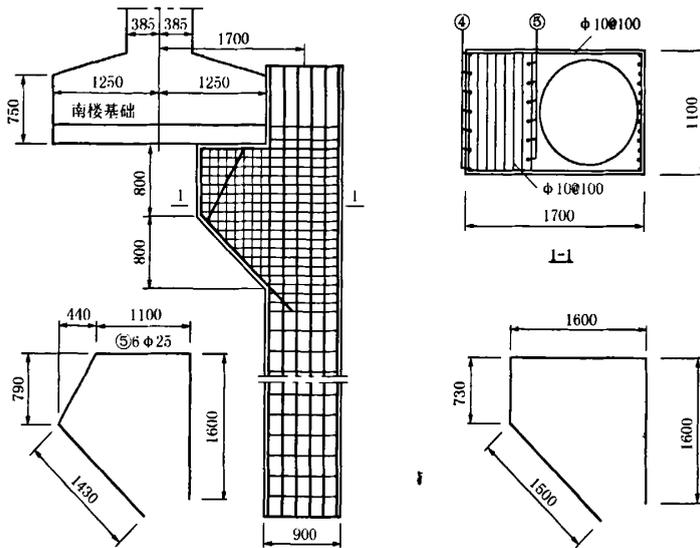
图 4 de 段托换支护两用桩大样图
