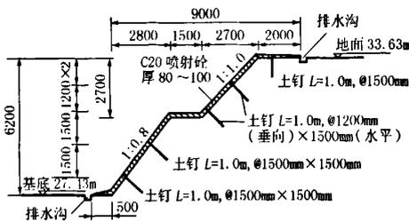
图2 二级放坡加喷锚支护剖面图
