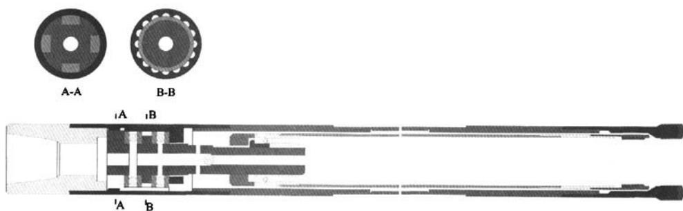
图4 普通取心钻具结构示意图
