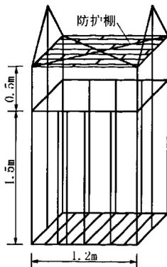
图6 吊笼结构简图
