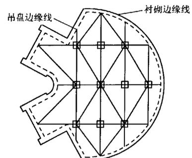
图5 吊盘结构平面图
