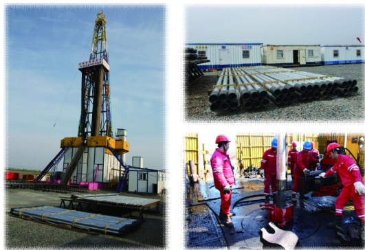
图4 Ø147 mm铝合金钻杆在“松科二井”生产试验
