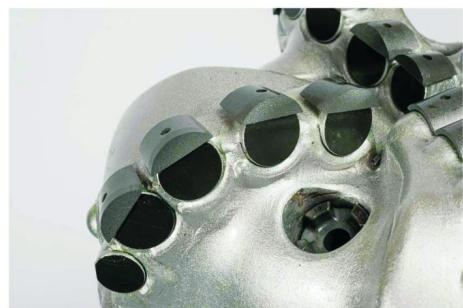
图 12 CuttPro 防剪切 PDC 保护帽
