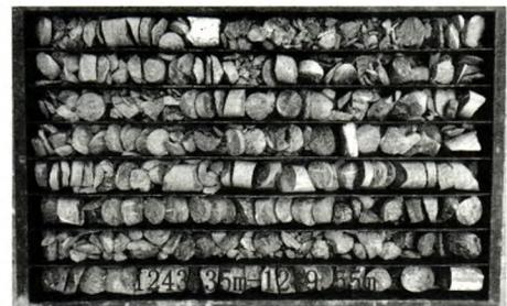
图 4 透孔水泥柱
