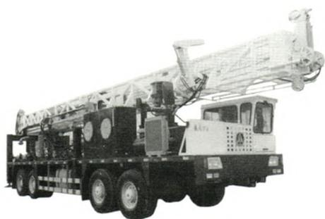
图3 SDC-1500型车载钻机
