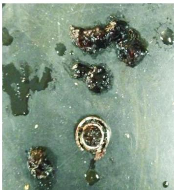
图9 小轴承被腐蚀
