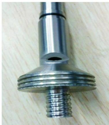
图14 螺旋防爬杆结构实物
