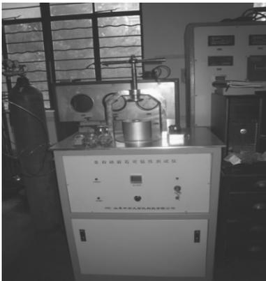
图2 岩石可钻性测试仪
