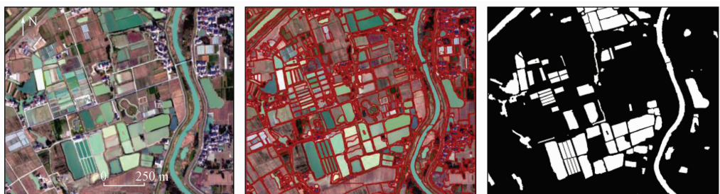
(a) 原始图像 (b) 图像分割结果 (c) CWI 提取结果
