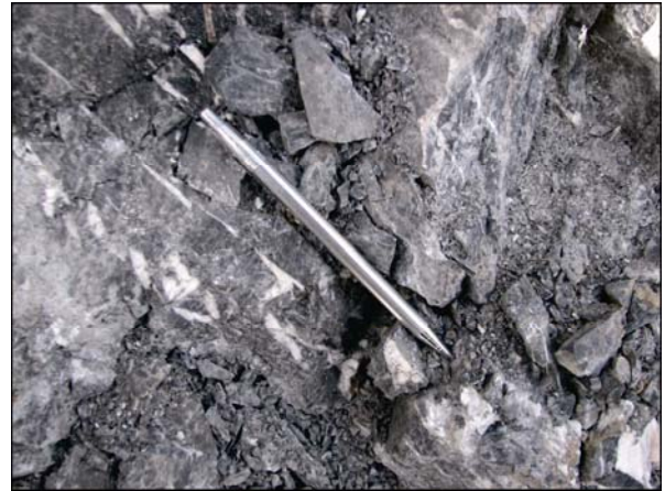
图 10 前部带灰岩中的“Z”型方解石脉 TWQ10(380949, 3286584), 剪切带产状 125°∠35°(右手, 175°)
