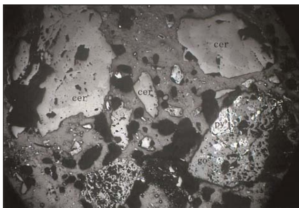
图 6 氧化矿石光片显微照片(反光 11×(—))
