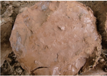
图 5 ZK2 中滑坡主滑面
