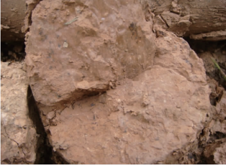
图 4 ZK1 中滑体内硬粘土扰动面
