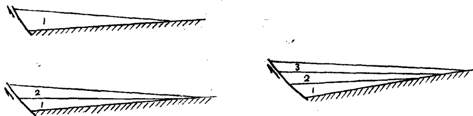
图6 同生断裂造成的地层倾角上倾收敛现象(自上而下代表三个发展阶段)
