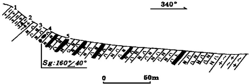
图2 舒城水竹河一带榴辉岩地质剖面图
