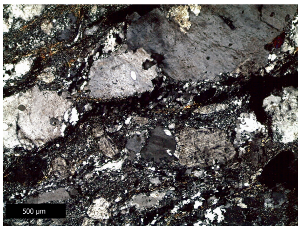
图4 黑云母二长片麻岩野外露头(上)及其镜下显微(下)照片(正交偏光)
