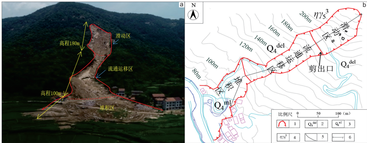
图1 黄梅县袁山村三组滑坡平面形态(a)及工程地质平面示意图(b)
