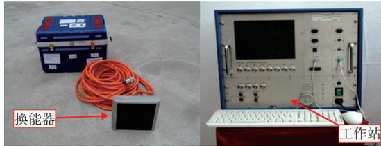
图 1 SES-2000 型参量阵浅地层剖面仪
