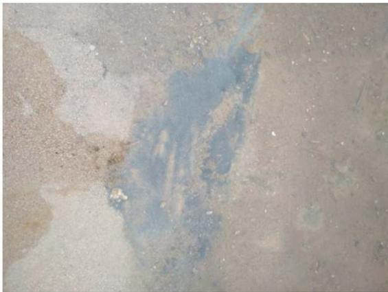
图 7 沙滩边缘土工布和原潮滩泥沙穿刺现象
