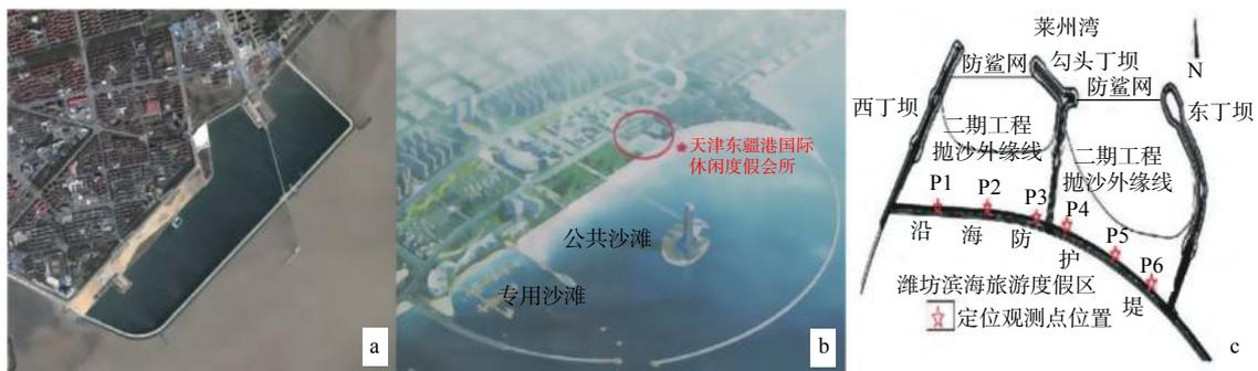
a) 上海金山封闭式围堰; b) 天津东疆半封闭式弧形围堰; c) 潍坊央子的鱼尾式丁坝群
