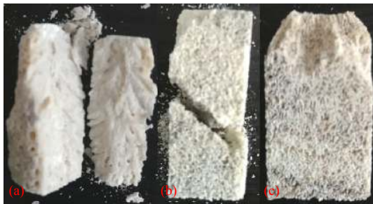
图 4 珊瑚试件的破坏方式
