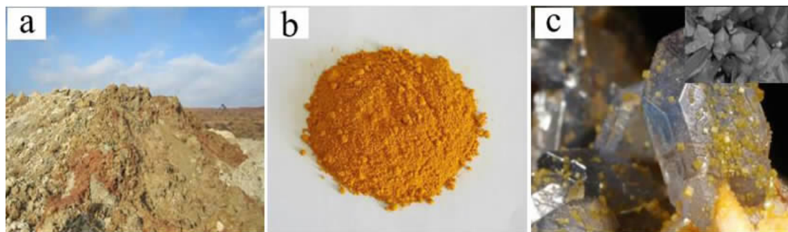
图5 各类含砷渣对比图(a. 钙砷渣/中和渣;b. 硫化砷渣;c. 臭葱石渣及扫描电镜图)
